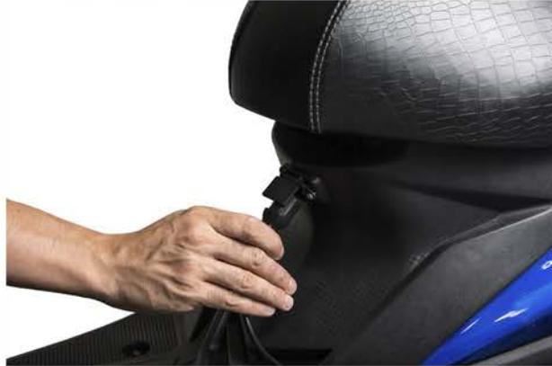
En el caso de la **Hawk** con batería de litio, si la misma es extraída del vehículo, es necesario encastrar la ficha de la batería a la del cargador, y luego conectar este último a la pared.
