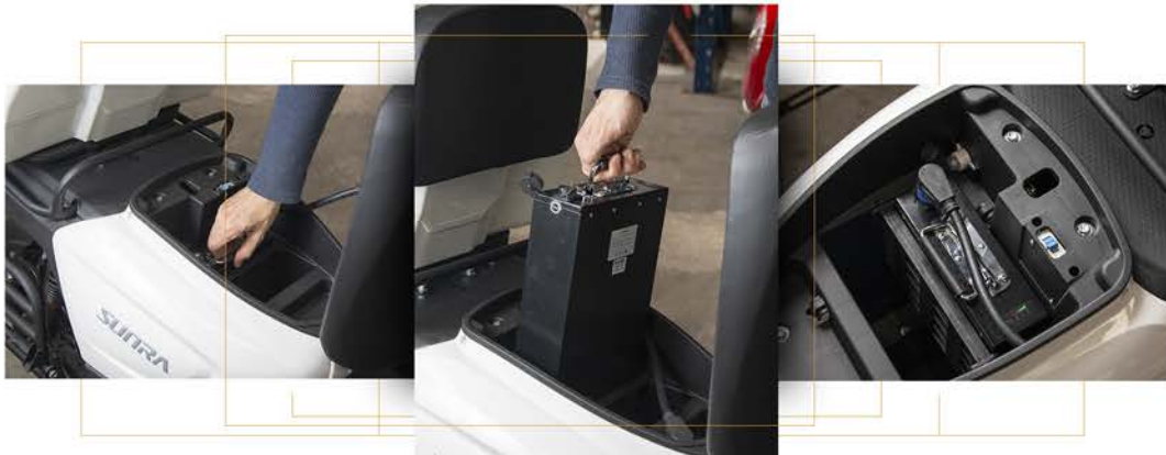
Batería de litio extraíble.
